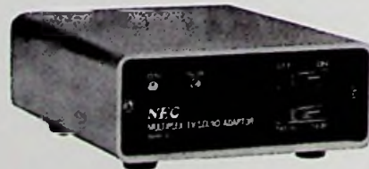
Afb. 4. TV-Audio-multiplex-adapter van NEC, waarmee men kan luisteren naar het originele geluid van de vertoonde film, dus niet naar de in Japan gebruikelijke na-synchronisatie in het Japans.
